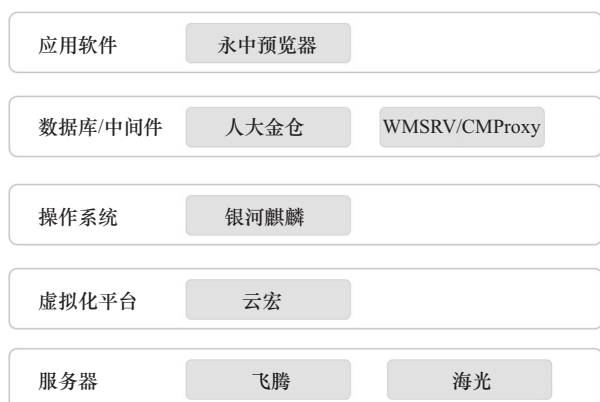
图2 信创电子邮件系统架构
